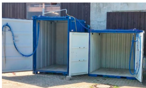
Bedampfungscontainer der Fa. Gebhardt Anlagentechnik GmbH & Co. KG in unterschiedlichen Größen mit Messtechnik auf dem LuV Jungborn der HfWU
